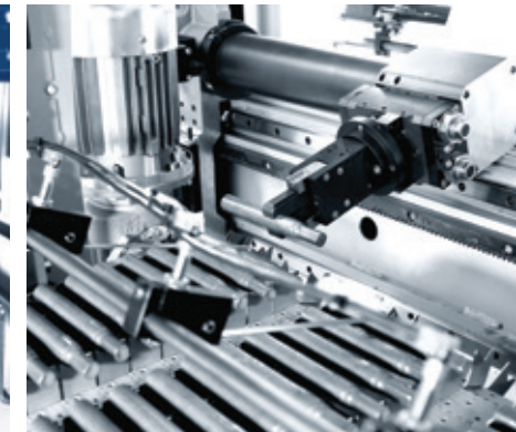
Taktförderband mit Prismenauflagen für unterschiedlich vorgeformte Wellenteile.
