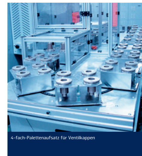
20-fach-Palettenmagazin mit kundenspezifischen Aufsatzpaletten
